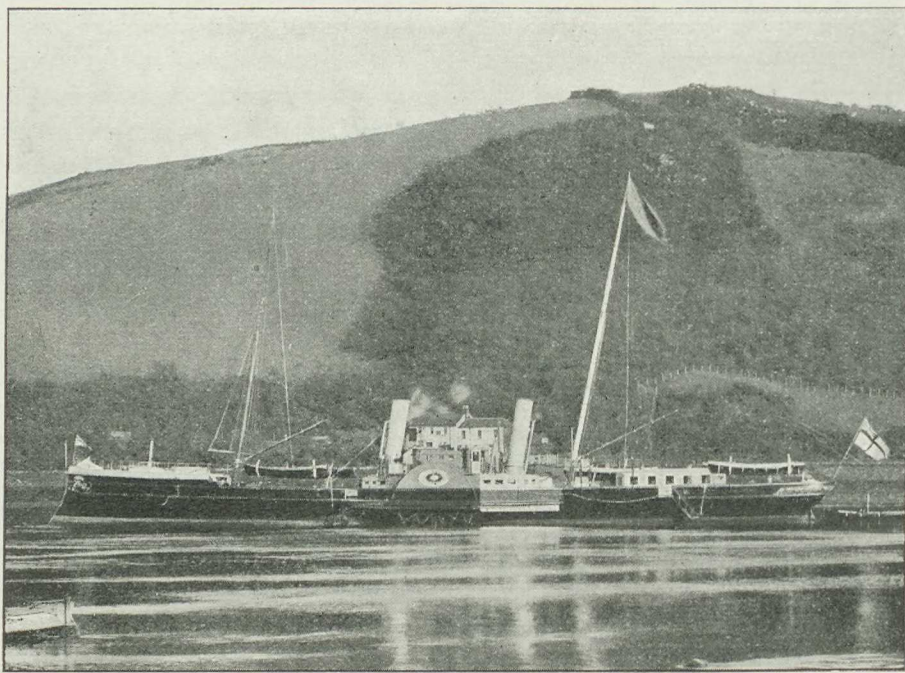
Fig. 31. Engelsk Admiralitetsyacht „Enchantress“, 230' \times 28', Dybgang 10' 6", Deplacement ca. 1000 Tons, IHK 1524. Sat i Vandet 1862. Omdrejninger pr. Minut 36. Diameter af Hjul 21' 4". (Efter et Fotografi i Dartmouth.)
