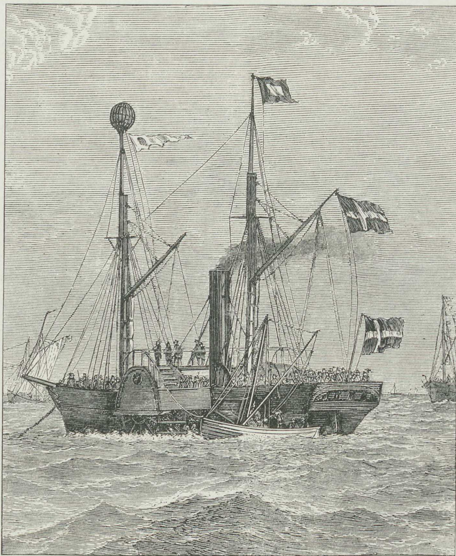
Fig. 129. „Hertha“. 90 HK, bygget 1844. 100' \times 19' med 6' 8" Dybgang, 47½ CL. Efter en Haandtegning af Carl Baagøe 1869. (III. Td.)
