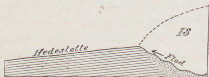
Fig. 52. Skematisk Billede, forestillende et lodret Snit gennem Indlandsisens Rand ved Toppunktet af en Hedeslette (til Forklaring af Smeltevandsflodernes Løb). (D. G. U.)
