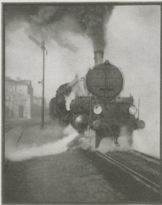
Abb. 21 Österreichische Vierzylinder-Verbund-Heißdampf-Schnellzuglokomotive (1-C-2) Reihe 310. Diese künstlerische Aufnahme ist uns von Herrn K. Pilanz, Linz, gütigst überlassen.
