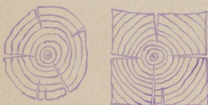
er fjernet; i Almindelighed opstaar Spalterne midt paa Sideone, hvor Modstanden er mindst. Et Bræt, som er skaaret ud gennem Midten af en Stammel, kan spalte sig gennem Midten paa Grund af starkere Sammentrækning efter Langden af de yderste Dele. I „Sidebrædder“ (udskaarne udenfor Midten) kan der fremkommet en konkav Krumning udefter, paa Grund af, at der er mere Splint paa denne Side.
