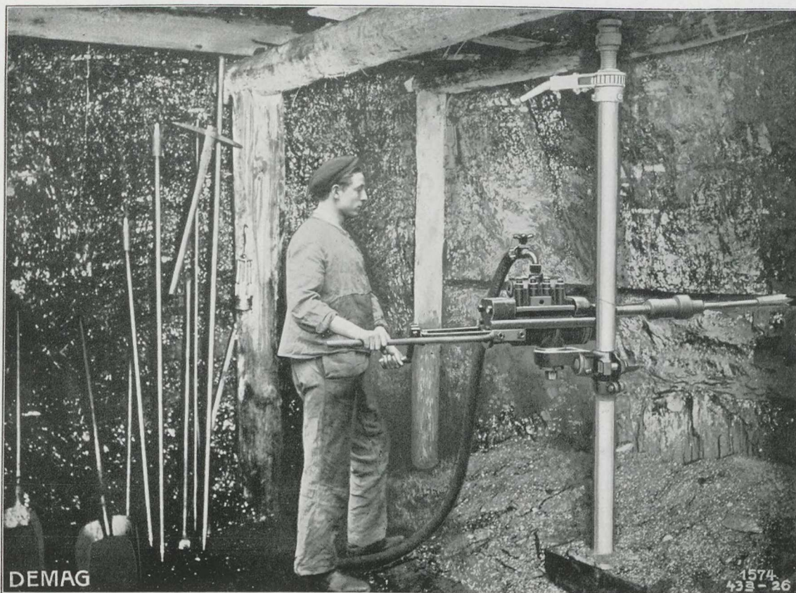
SCHRÄMMASCHINE MIT UNIVERSALKUPPLUNG UND HANDEHEBEL
