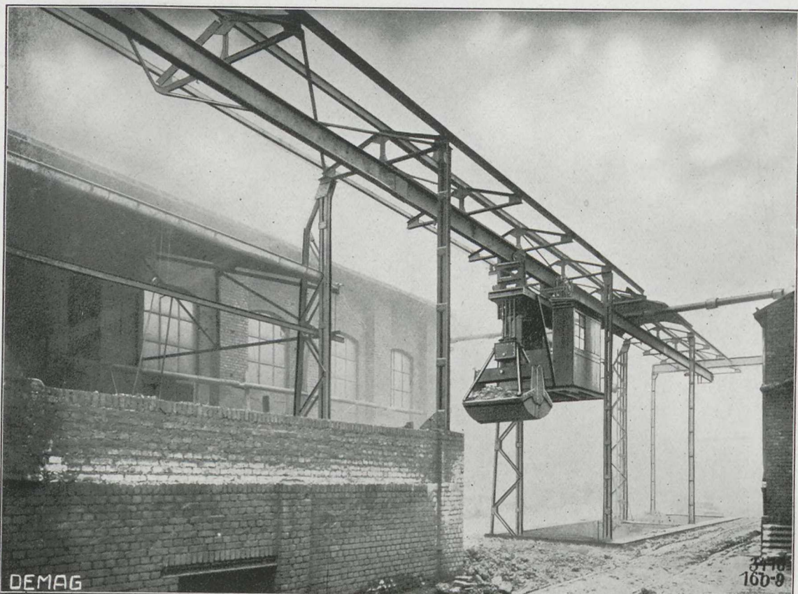
EINSCHIENENLAUFKATZE MIT SELBSTGREIFER ZUM TRANSPORT VON ERZ UND KOHLE
